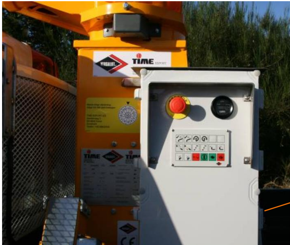
Voobeeld op een alternatieve onderste bediening voor kleine vrachtauto's en chassis Ingebouwd in een kast Figuur 4-5-5
