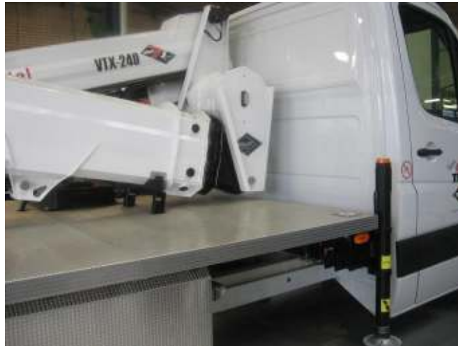
Ondermast in maststeun. Fig. 4-7-1-A
