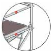
Afbeelding 84: Verbinding van de staanders met borg-pennen
