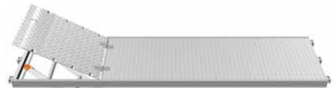
Passage robuustvlonderT9, buisoplegging, 0.61 m breed met geïntegreerde ladder*, Art.nr. 3872.xxx, 2.57 – 3.07 m
