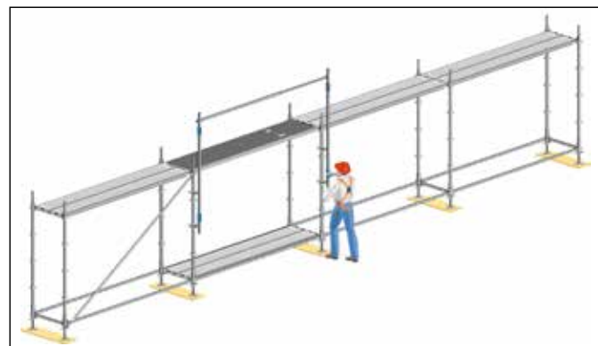
Afbeelding 18: Gebruik van een montageleuning bij niveauwisseling
