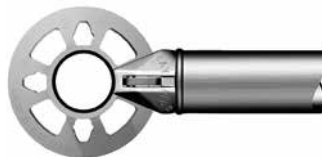
Afbeelding 3 Layher Allround LightWeight volgens Zulassungsnummer (Z-8.22-939)
