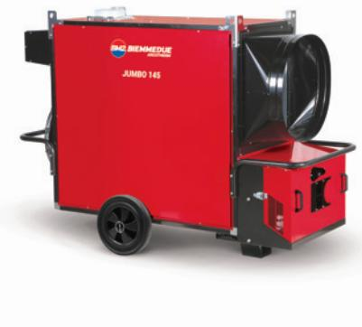
**JUMBO:** a combustione indiretta, macchine di grande dimensione per ambienti più voluminosi, possono montare indifferentemente un bruciatore esterno a gasolio, GPL o metano. Equipaggiate con ventilatore assiale rispondente alle normative ERP 2015 sono un ottimo compromesso per rendimento (93%), silenziosità e prevalenza, caratteristica consigliabile in particolare per montaggi ove sono previste canalizzazioni.
