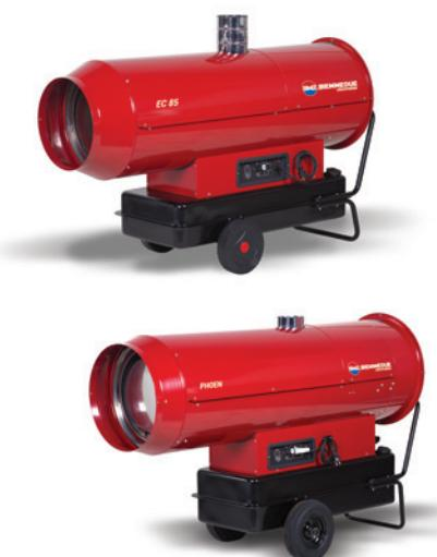
**EC e PHOEN:** alimentati a gasolio, con bruciatore integrato (EC) e separato (PHOEN) dal ventilatore, a combustione indiretta: impiegano uno scambiatore di calore che permette l'evacuazione dei fumi attraverso un cammino collegabile con l'esterno; possono quindi essere collocati all'interno di locali chiusi, per contro hanno un costo più elevato ed un rendimento intorno al 90%, dovendosi calcolare, in riduzione, la quantità di calore evacuata attraverso il cammino.
