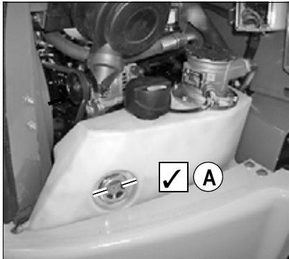
afb. 176: Oliekijkglas op tank voor hydraulische olie
