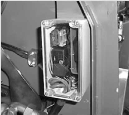
afb. 190: Hoofdzekeringkastje in de motorruimte
